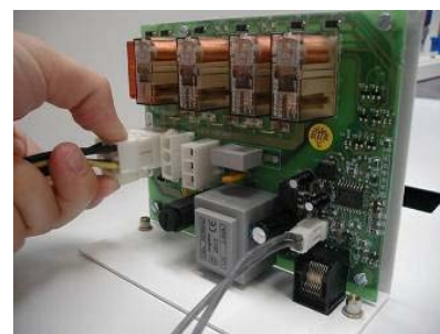
Dra ut de 2 tilkoblingsklemmene som er festet til krets-kortet, ved å klemme på siden.
