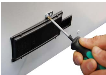
Fjern jordings-skruen fra tilkoblingsboksen og løsne fra kabinettet.
