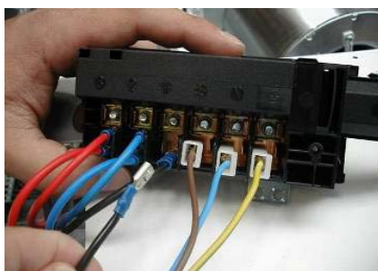
Koble fra kablene til 1,2 og 3 i koblingsboksen.
